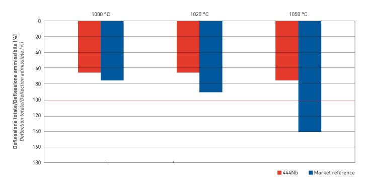
Deflessione dei provini dopo 100h di esposizione in temperatura. I campioni sono poggiati su dei supporti in modo da essere sottoposti all'azione del proprio peso (la deflessione massima ammissibile è funzione dello spessore dei campioni). Spessore riferimento: 2 mm
