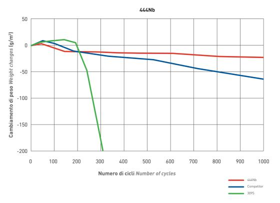
Variazione di peso per unità di superficie in funzione del numero di cicli termici cui è sottoposto il materiale (un ciclo: 25'alla temperatura di prova, 5' a temperatura ambiente.
