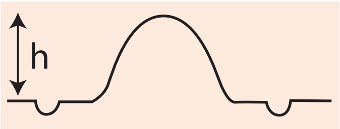
Schema del calcolo dell'indice Erichsen. Calculation method of Erichsen Index.
