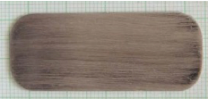
Resistenza alla corrosione generalizzata in H_2SO_4 [0,5N]+HBr [0,01N] a 50 °C, tempo di esposizione 168h (ASTM G157 modificato). Resistance to generalised corrosion in H_2SO_4 [0.5N]+HBr [0.01N] at 50 °C, exposure time 168h (ASTM G157 modified).
