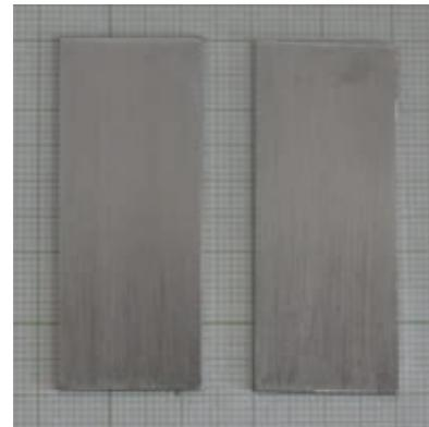
Resistenza alla corrosione generalizzata in  $H_2SO_4$  (0,5N)+HBr (0,01N) a 50 °C, tempo di esposizione 150h (ASTM G157 modificato).
