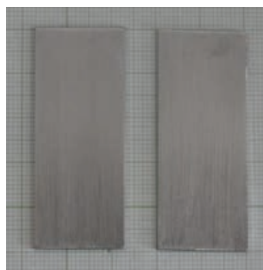
Resistenza alla corrosione generalizzata in H_2SO_4 (0,5N)+HBr (0,01N) a 50 °C, tempo di esposizione 150h (ASTM G157 modificato). General corrosion rate in H_2SO_4 (0.5N)+HBr (0.01N) at 50 °C, exposed for 150h (modified ASTM G157).
