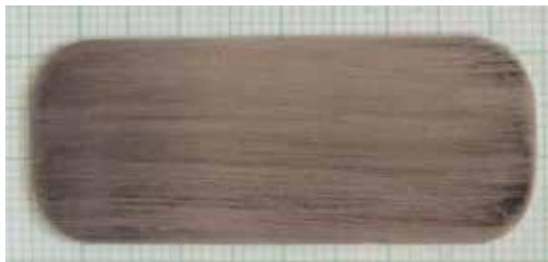
Resistenza alla corrosione generalizzata in H<sub>2</sub>SO<sub>4</sub> (0,5N)+HBr (0,01N) a 50°C, tempo di esposizione 168h (ASTM G157 modificato).
