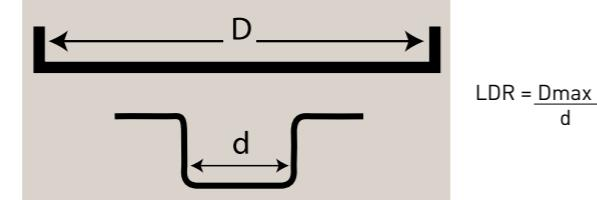
Schema del calcolo dell'indice Erichsen e del LDR (test Swift).
