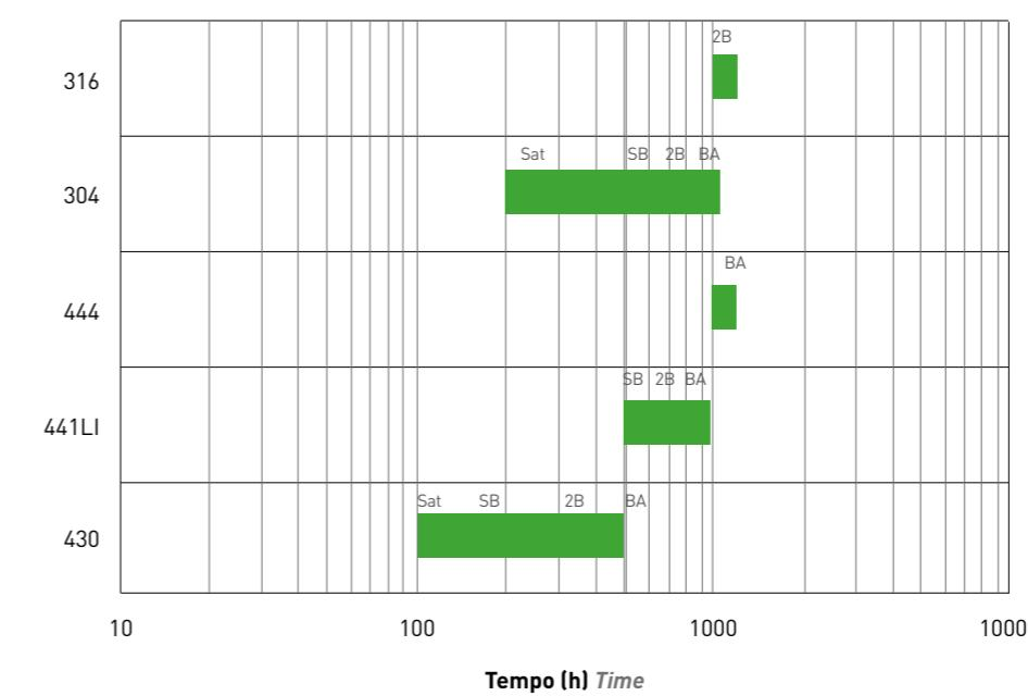
Resistenza in camera a nebbia salina in funzione della finitura superficiale (test eseguito secondo standard ASTM B117).
